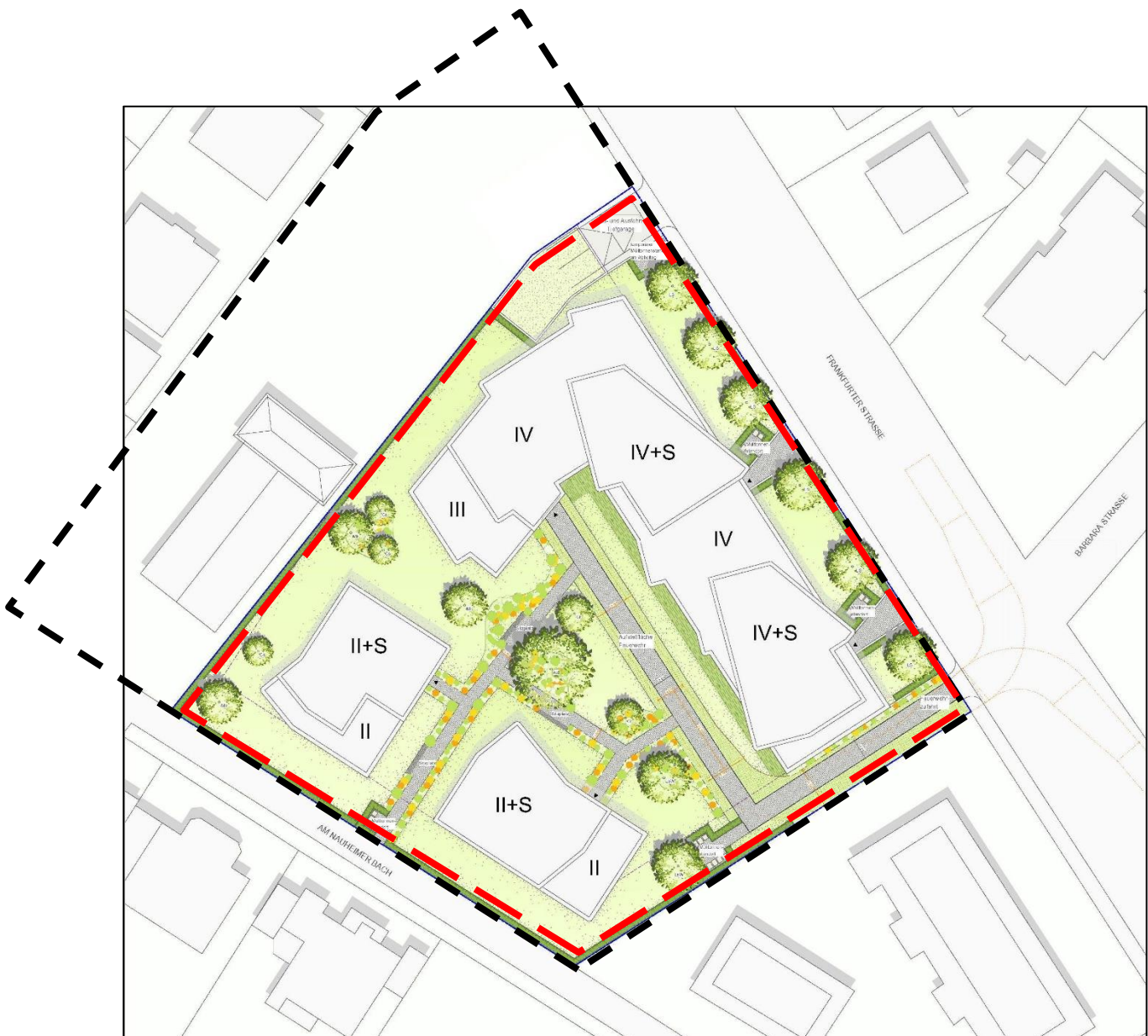
Abbildung 6: Städtebauliches Konzept / Lageplan Vorhaben mit Freianlagenkonzept (markiert = Geltungsbereich Bebauungsplan Nr. 73 "Ehemalige Zahnfabrik", rot markiert = Bereich des Vorhaben- und Erschließungsplans)
